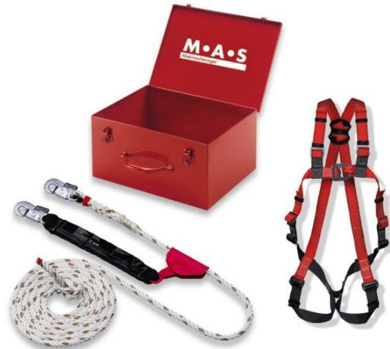
Die Zusammenstellung dieser Ausrüstung ist besonders für Dachdecker und Zimmereien geeignet, da der Auffanggurt eine vordere Auffangöse besitzt, die es ermöglicht in Blickrichtung des Anschlagpunktes zu arbeiten, wie es bei Dacharbeiten häufig der Fall ist.
