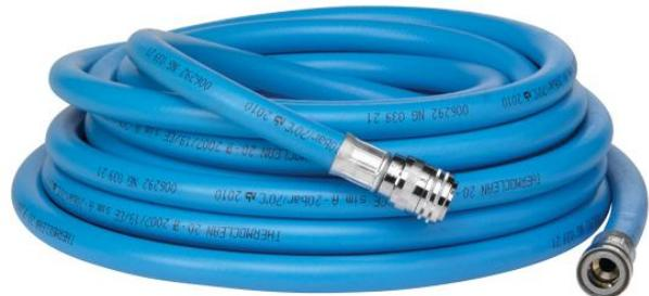
Dieser Heißwasserschlauch ist ideal für die Reinigung mit Wasser bis zu 70° C. Er ist mit einer 1/2" Q-Kupplung in beiden Schlauchenden ausgestattet. Wasserhahnippel Art. 9060700 ist für die Gewindearten 1/2", 3/4" und M22x1 vorgesehen. Kann mit den folgenden Vikan Q-Kupplungen 9060700, 9060705 und 9060712 sowie anderen Vikan Produkten verwendet werden, die mit einem 1/2" Q-Nippel ausgestattet sind.
