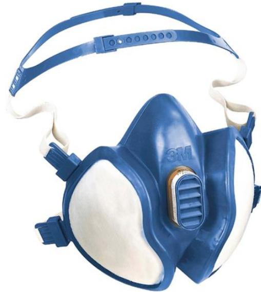
Die 3M™ Maske für Farbspritzarbeiten 4255 ist unsere wartungsfreie Hybrid-Atemschutz-Halbmaske, die eingesetzt werden kann, bis sie wegen Beschädigung, Verstopfung oder Sättigung auszusondern ist. Sie verfügt über ein Doppel-Einatemventil, große Aktivkohlefilter und ein Ausatemventil mit geringem Widerstand, um das Atmen angenehmer zu machen.
